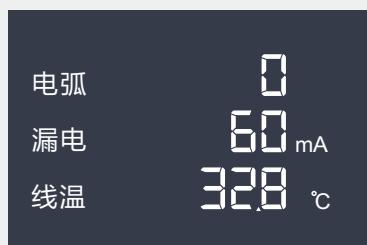
电弧0次 漏电60mA 线温32.8℃
